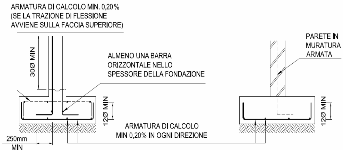
Figura 4. Particolari costruttivi: fondazioni di muri.
