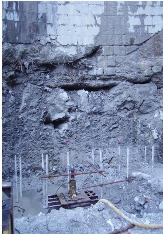
Figura 14. Dispositivo di prova dei tiranti, con martinetto cilindrico utilizzato in modalità “a spinta”, flessimetri centesimali per il controllo delle deformazioni e piastra nervata basale di contrasto.
